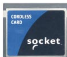
▲ Die Bluetooth-Erweiterungskarte von Socket verschwindet völlig im CF-Steckplatz
