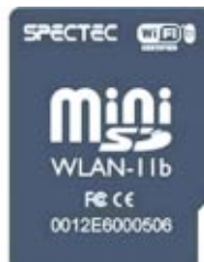
Auch für den winzigen Mini-SD-Steckplatz baut Spectec eine WLAN-Karte ▶
