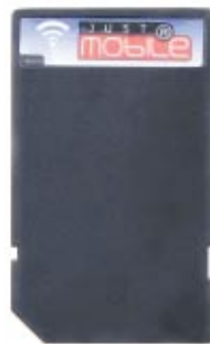
Auch für den winzigen Mini-SD-Steckplatz baut Spectec eine WLAN-Karte ▶
