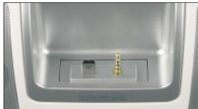
Über diese beiden Stecker, Mini-USB und 2,5-Millimeter-Klinke, rastet der Pocket-PC ein
