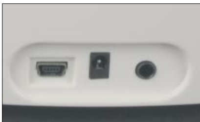
Auf der Rückseite steckt man ein USB-Kabel zum Synchronisieren ein. In der Mitte liegt die Buchse für das Netzteil, rechts die 3,5-Millimeter-Buchse für eine weitere Klangquelle.
