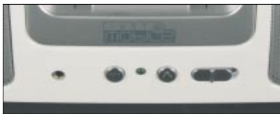
Links wird das Headset eingesteckt, mit den beiden mittleren Knöpfen regelt man die Lautstärke, und mit dem Schiebeschalter rechts macht man das Gerät aus
