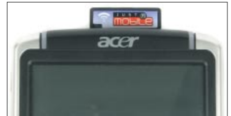
Nur 8 Millimeter stehen die beiden WLAN-Karten aus dem Pocket-PC hervor - das reicht für einen sehr guten Empfang
